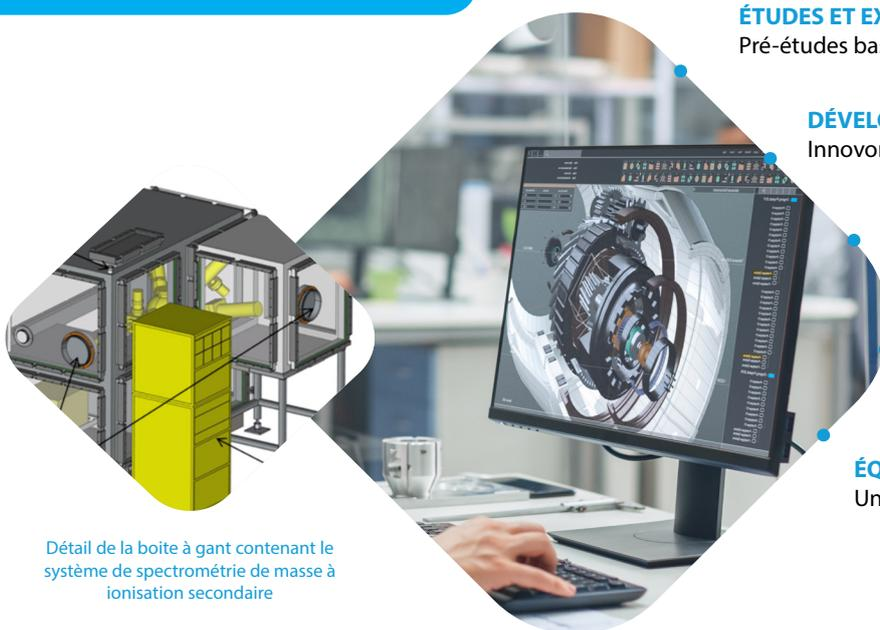
Détail de la boîte à gant contenant le système de spectrométrie de masse à ionisation secondaire
