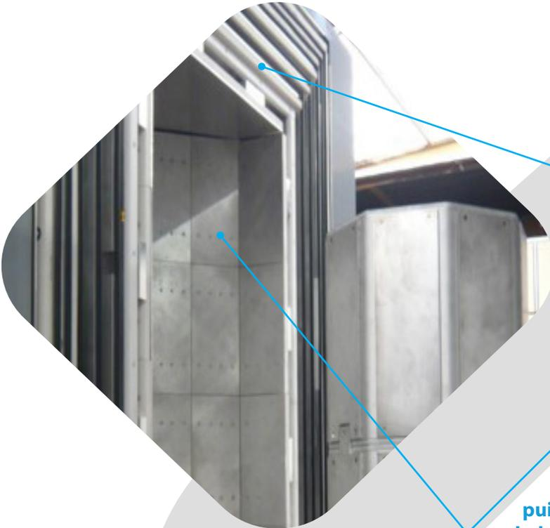
La qualité de la mesure repose également sur une **régulation fine de la température des colis**, grâce à un ensemble de régulation à air ou à eau et d'isolation multicouches.
