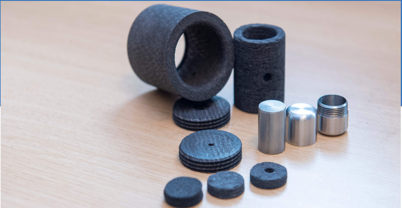
Prototype d'unité de chauffage à radioisotope (RHU) développé par l'Université de Leicester pour l'Agence spatiale européenne. Crédit : ESA - G. Porter
